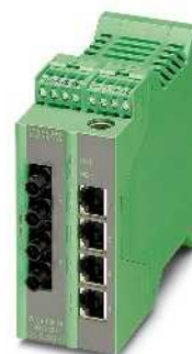
4 portas RJ45 e 2 portas para fibra óptica no formato ST (monomodo)
