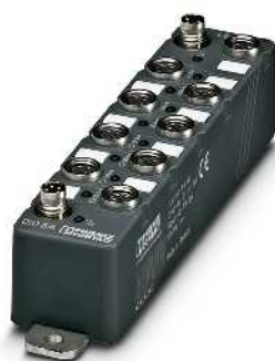
4 entradas digitais e 4 entradas ou saídas digitais
