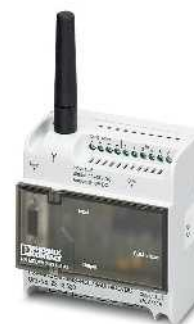
Sistema remoto de comunicação e sinalização SMS com seis entradas e quatro saídas à relé
