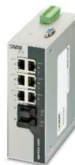
6 portas RJ45 e 2 portas para fibra óptica (monomodo)
