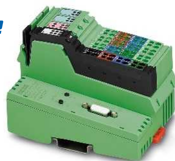
Conexão D-SUB, 8 entradas digitais e 4 saídas digitais
