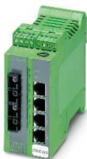
4 portas RJ45 e 2 portas para fibra óptica (monomodo)
