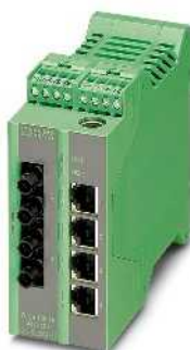
4 portas RJ45 e 2 portas para fibra óptica no formato ST (multimodo)
