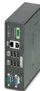
Box PC com faixa de temperatura ampliada
