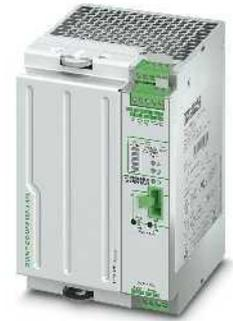
Fonte de alimentação ininterrupta com acumulador de energia integrado, 24 V CC / 24 V CC, 10 A, 3.4 Ah
