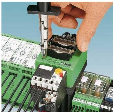
tro de 50 mm for aplicada uma força de 50 N e isso não resultar em nenhum contato com as peças com perigo de contato do equipamento. Fora desta faixa, não estão previstas medidas especiais para a segurança de contato.
