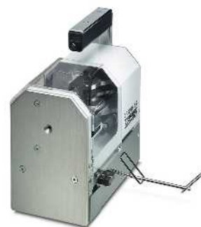
Perfil de condutor de 0,25 até 2,5 mm 2
